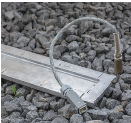
Verblüffend unkompliziert: Heizsystem mit Überwachung der Heizkreise.
