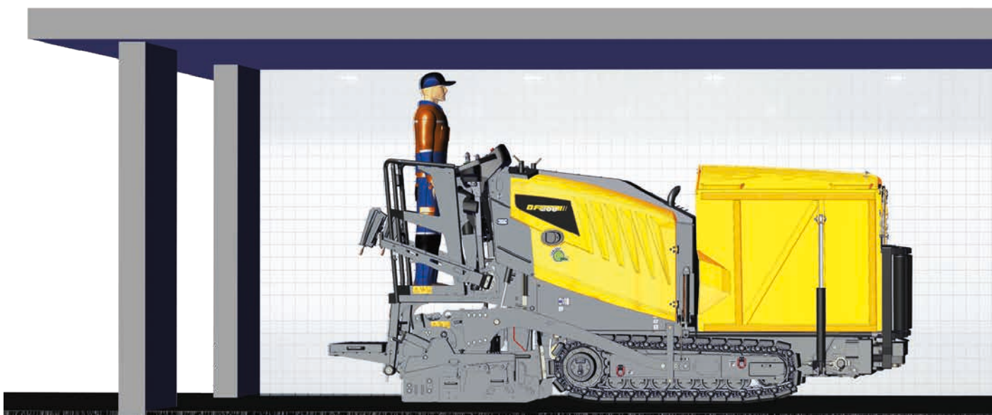
Passt überall durch – selbst durch eine Fußgängerunterführung mit nur 2 m Höhe.
