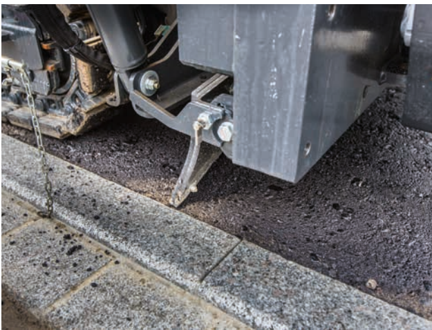
Kettenabstreifer garantieren einen geringen Wartungsaufwand.
