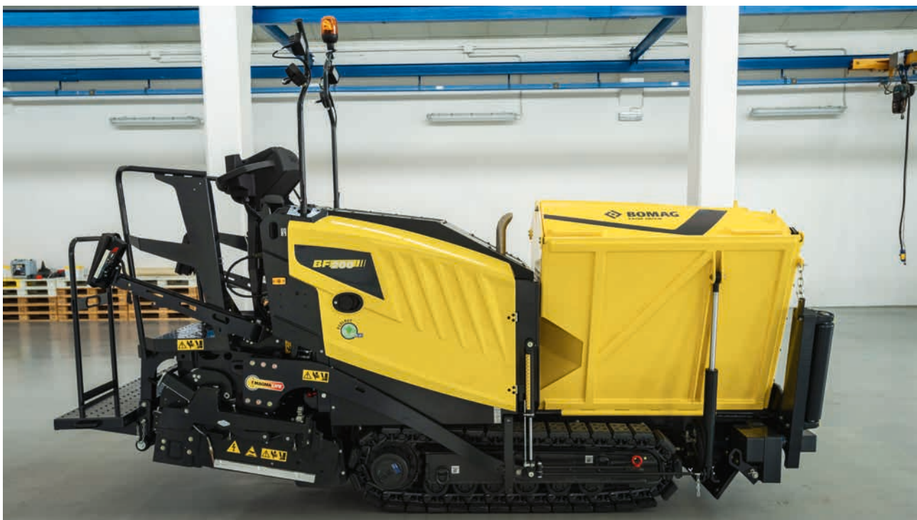
Einzelsteuerung der Kette erlaubt Wenden auf engstem Raum.
