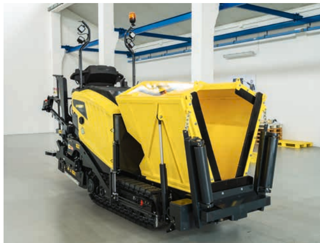
Lange Kettenlaufwerke sorgen für schnurgeraden Einbau.
